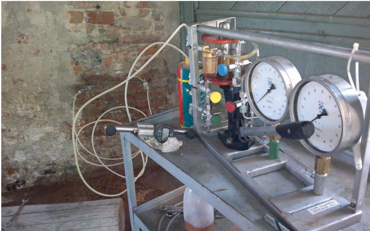
La prova consiste nella realizzazione di un taglio perpendicolarmente alla superficie di una struttura per creare una variazione nello stato tensionale della stessa. All'interno del taglio si inserisce il martinetto, il quale attraverso la pompa manuale viene ripressurizzato per incrementi di carico costante fino al ripristino della tensione iniziale.
