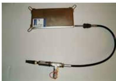
La cella è dotata di una valvola di ripressurizzazione per l'attacco alla pompa manuale ad olio.
